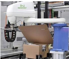
**CVP-500**, le système de colisage automatique qui emballe en temps réel chaque commande dans un colis sur-mesure avec une productivité 10 fois supérieure à un traitement manuel.
